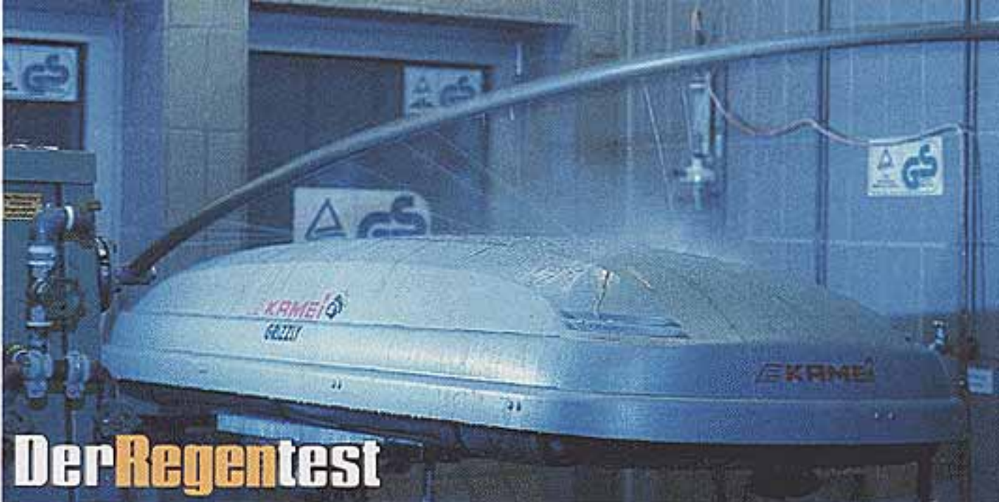
Mit fünf Litern pro Minute prasseln feine Wasserstrahlen auf die Dachbox ein. Nur eine exakt passende Dichtung mit ausreichender Überlappung ist diesem Test gewachsen
