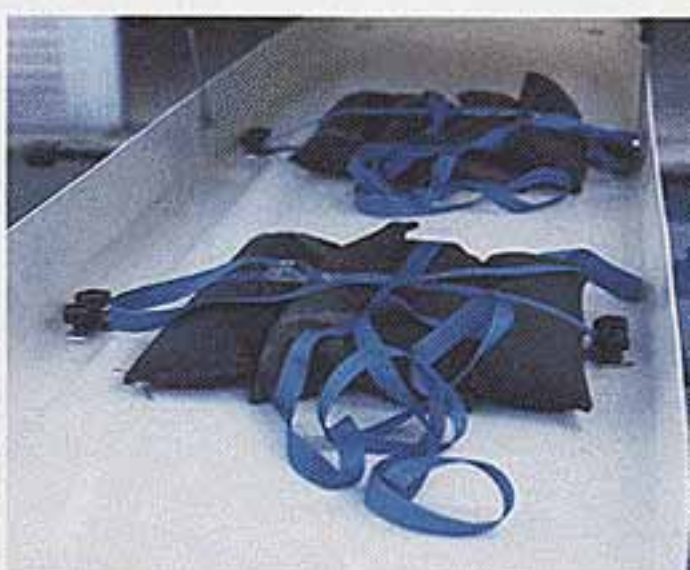
DIE ZULADUNG simulieren wir mit Ballastsäcken mit je zehn Kilogramm Eigengewicht
